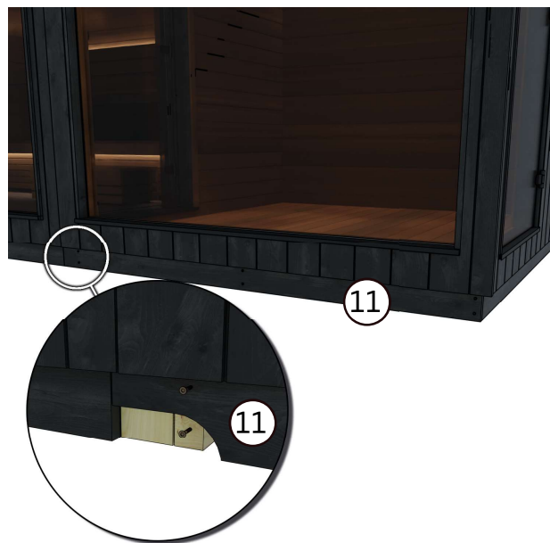
10. Kiinnitä sokkelilaudat ( 11 ) moduulin kuljetustukiin. Sokkelilaudat tulevat asentamasi täytepalan päälle. Asenna sokkelilauta samantyyppisillä myös taakse.
