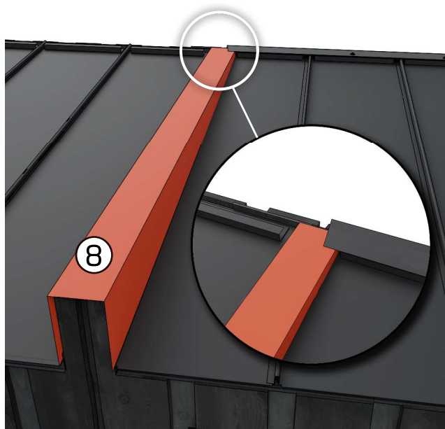
11. Asettele ja kiinnitä U-pelti ( 8 ) moduulien väliin. Käytä kiinnittämiseen ruuveja ( 9 ). Molemmille puolille tulee viisi kappaletta ruuveja.
