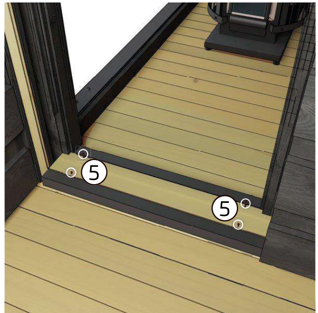
11. Bevestig de drempel met schroeven ( 5 ). De drempel heeft voorgeboorde gaten.
