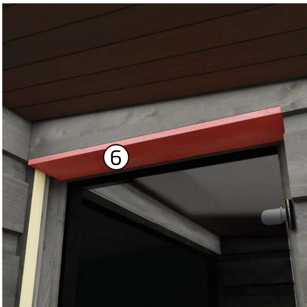
12. Kiinnitä Smyygilauta lyhyt ( 6 ) saunan ja pukuhuoneen oviaukon ylös. Smyygilauta tulee päin saunan oven karmeja. Smyygilauta kiinnitetään kolmella ruuvilla ( 5 ). Smyygilaudassa on reiät valmiina.
