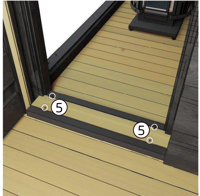
11. Kiinnitä astinlauta ( 4 ) neljällä ruuvilla ( 5 ). Astinlaudassa on valmiit reiät valmiina.
